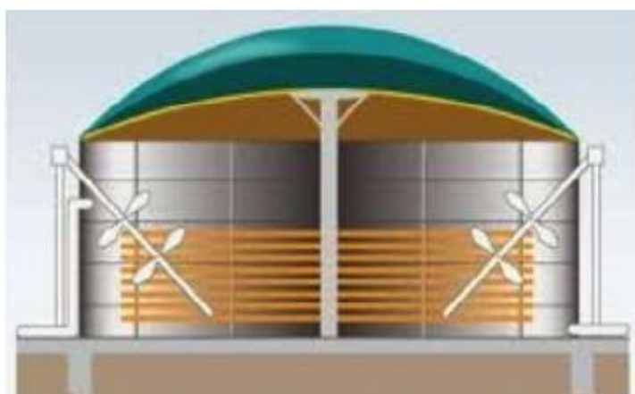
Figura 3.9 – Representação esquemática de um reator CSTR com dupla membrana
